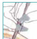
Temperatursonde einführen und Kompressionskappe festziehen
