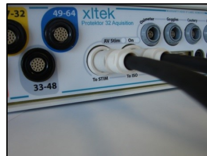
Figura 13: centralina di acquisizione collegata alla centralina dello stimolatore
