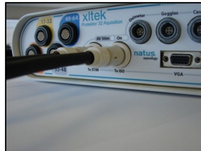
Figura 12: cavo di isolamento-acquisizione collegato alla centralina di isolamento
