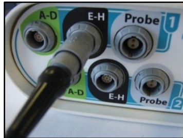
Figura 25: Cable de estimulación conectado a la caja del estimulador
