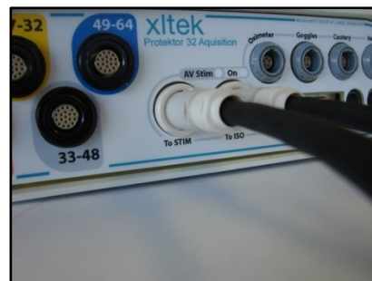
Figura 23: Caja de adquisición conectada a la caja del estimulador
