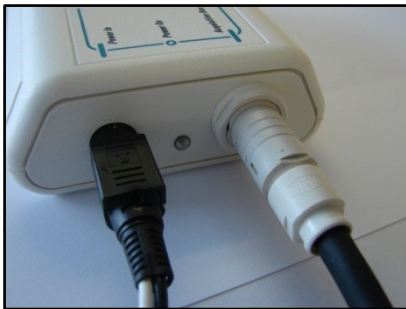
Figura 12: cavo di isolamento-acquisizione collegato alla centralina di isolamento
