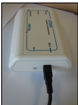
Figura 29: Caixa de Isolamento ligada ao computador portátil
