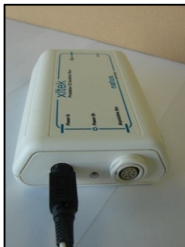
Figura 26: Alimentação ligada à caixa de entrada
