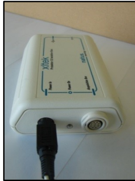
Figura 21: Cable de alimentación conectado a la caja amplificadora
