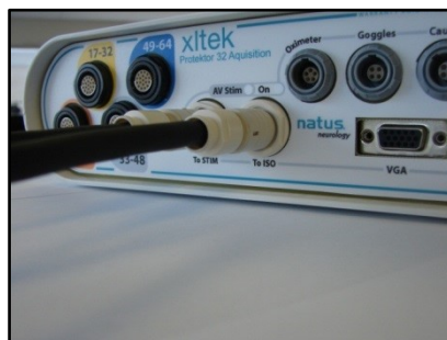
Figura 27: Cabo de Isolamento-Aquisição ligado à caixa de Isolamento
