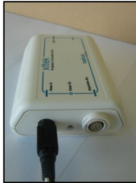
Abbildung 16: Stromversorgung an die Headbox angeschlossen
