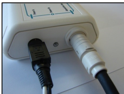
Figura 27: Cabo de Isolamento-Aquisição ligado à caixa de Isolamento
