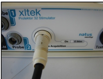
Figura 13: centralina di acquisizione collegata alla centralina dello stimolatore
