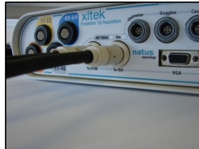
Abbildung 17: Trenn-/Erfassungskabel an die Trennbox angeschlossen
