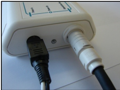
Abbildung 17: Trenn-/Erfassungskabel an die Trennbox angeschlossen
