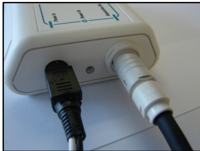
Figura 22: Cable de aislamiento-adquisición conectado a la caja de aislamiento
