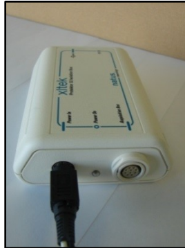
Figura 11: alimentazione collegata alla headbox
