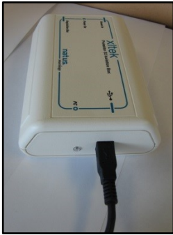
Figura 24: Caja de aislamiento conectada al ordenador portátil
