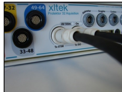
Abbildung 18: Erfassungsbox an die Stimulationsbox angeschlossen
