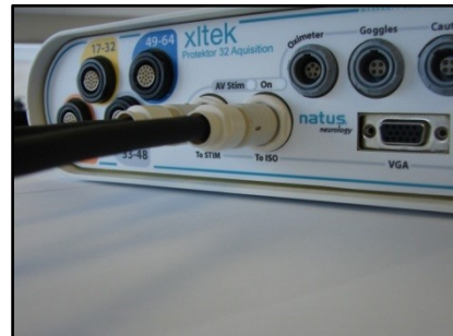
Figura 22: Cable de aislamiento-adquisición conectado a la caja de aislamiento
