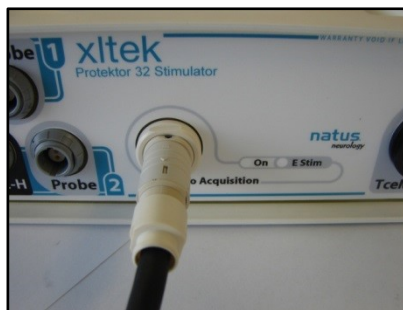
Figura 23: Caja de adquisición conectada a la caja del estimulador
