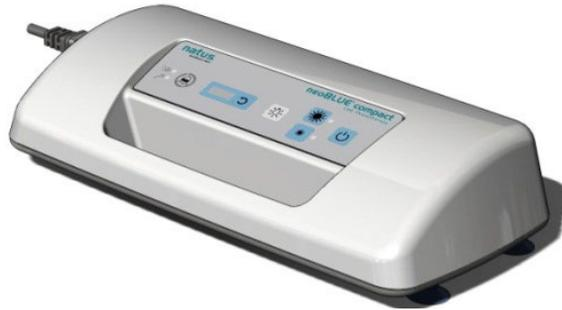
**Aberturas de ventilación:** hay una rejilla de ventilación en la parte posterior del bastidor de la lámpara. El ventilador evita que la unidad se sobrecaliente. En la parte inferior del bastidor hay una rejilla de entrada pasiva de aire. Esta rejilla de entrada de aire tiene un filtro que debe limpiarse con regularidad (consulte la sección 6.3, «Limpieza»). Si el ventilador deja de funcionar, póngase en contacto con el Servicio técnico de Natus o con su proveedor de servicio autorizado.
