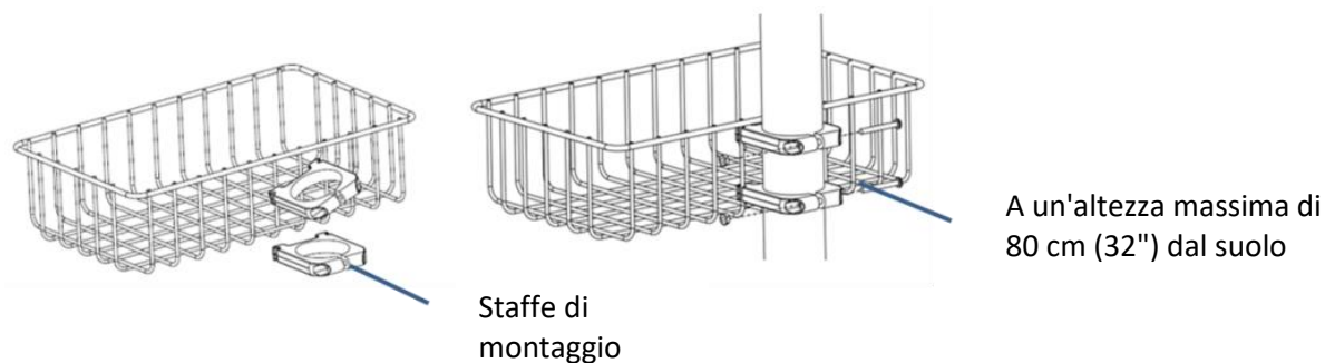
Figura 2: montaggio del cestello per accessori
