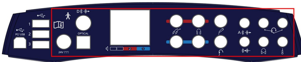
Fig. 1 Tomadas com conexões diretas a transdutores de paciente - AURICAL Aud painel de conexão
