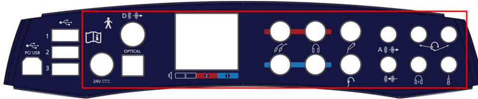
Kuva 1 Liittimet, joista suora yhteys potilaan kuulokkeisiin - AURICAL Aud-kytkentäpaneeli
