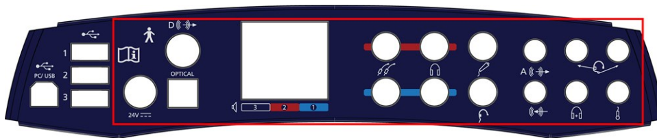
Ábra 1 A páciens jelátalakítók közvetlen csatlakozóinak csatlakozó aljzatai – AURICAL Aud csatlakozó panel
