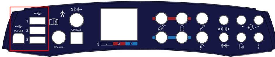
Fig. 2 Aansluitingen die geïsoleerd zijn van de patiëntentransducers - AURICAL Aud-aansluitpaneel
