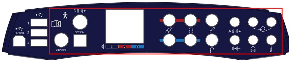
Fig. 1 Aansluitpunten met rechtstreekse aansluiting op patiëntentransducers - AURICAL Aud-aansluitpaneel
