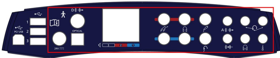
Şek. 1 Hasta dönüştürücülerine doğrudan bağlantılı soketler - AURICAL Aud bağlantı paneli
