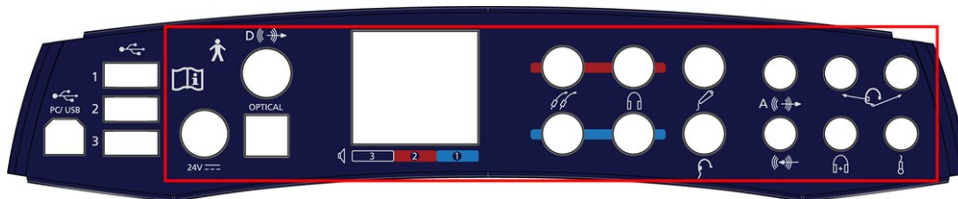
Fig. 1 Stik med direkte forbindelse til patienttransducere - AURICAL Aud tilslutningspanel
