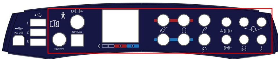
Fig. 1 Tomas con conexiones directas a los transductores del paciente - Panel de conexión del AURICAL Aud
