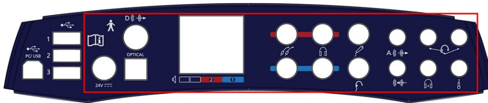
Fig. n° 1 Prises de connexion directe au transducteur du patient - panneau de connexion du AURICAL Aud
